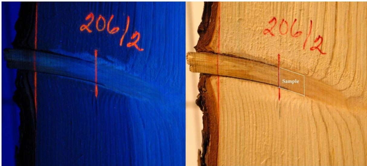
Kuva 5. Sisäoksa mäntyrunгон pitkittäisleikkauksessa. Vasemmalla on UV-säteilylähteen alla otettu kuva ja oikealla huonevalaistuksessa otettu kuva. UV-säteily (n. 315-318 nm aallonpituus) paljastaa eri sinisen sävyinä ilmenevänä fluoresenssina asioita, joita ei näy huonevalaistuksessa. Männy sydänpuu erottuu kirkkaan sinisenä sekä runkopuussa että sisäoksassa ja pintapuu näyttäytyy tumman sinisenä. Kummassakin kuvassa näkyy sekä tervettä että kuollutta, ruskeareunaista, sisäoksaa. (Kuvan näytteenottokohta viittaa julkaisussa Karppanen ym. (2007) tutkittuun sisäoksa-aineistoon.)
