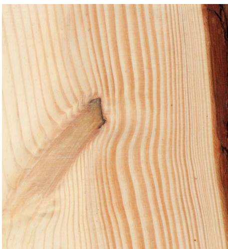
Kuva 6. Pystykarsinnan jälkeen nopeasti kylestynyt sisäoksa. Kuva: Luke/Erkki Oksanen
