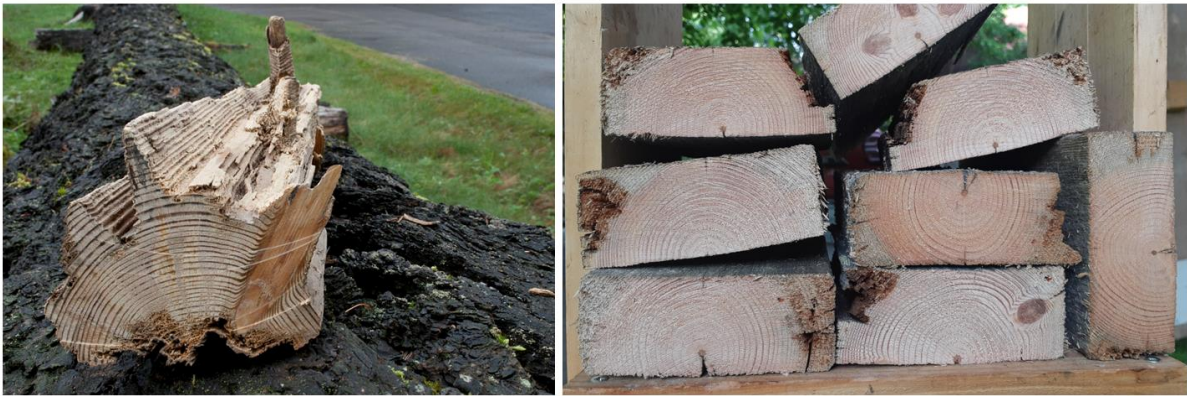
Kuva 19. Luontaisten uuteaineiden kyllästämä männyn sydänpuu on jäänyt jäljelle, kun pinta-puu on lahonnut pois kokonaan tai osittain. Vasemmalla on vuosikymmenten ajaksi maako- ketukseen joutunut heinäladon alin hirsi. Oikealla puolella olevat, polttopuuksi sahatut lankut ovat olleet säälle alttiina noin 20 vuotta, mutta eivät maako- ketuksessa.
