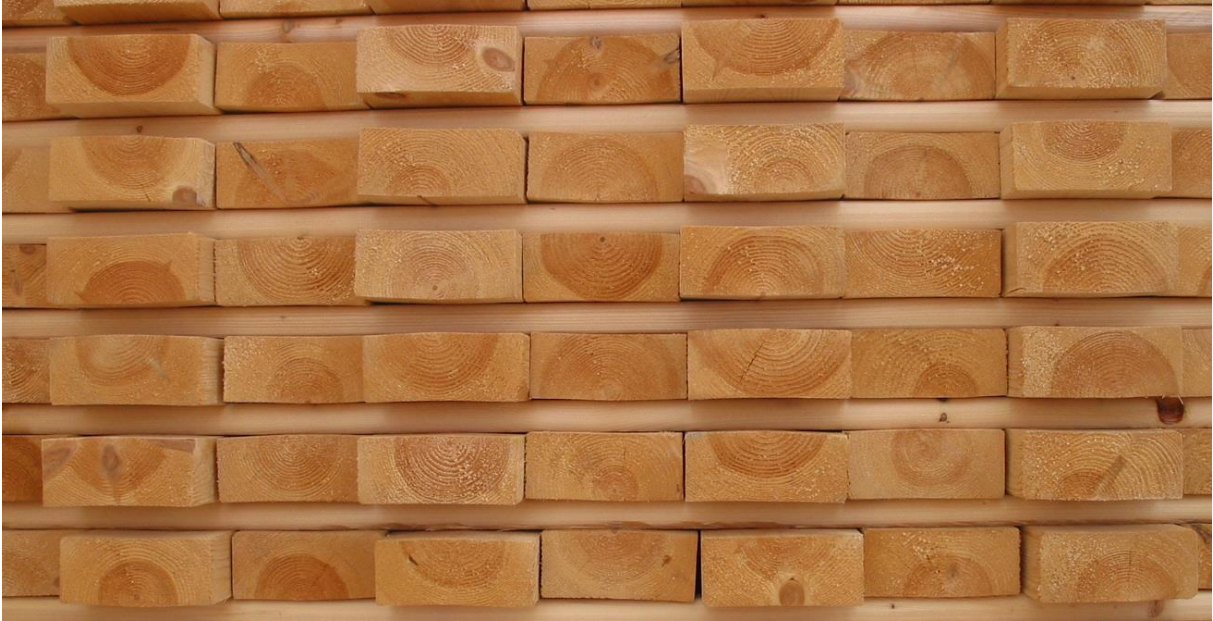
Kuva 27. Sydän- ja pintapuuta sisältäviä keskitavaralankkuja, joissa on mukana myös sydänpuuksi muuttunut nuorpuu.
