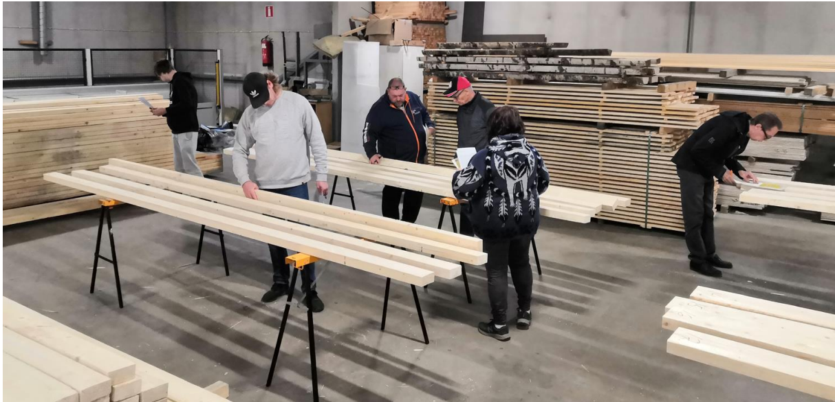
Kuva 29. Koulutuksen saanut henkilö voi tehdä mäntypuutavaran lujuuslajittelun silmänvaraisesti INSTA 142 -standardin mukaisesti. Kuva: Jouni Silvast/Metsäkeskus.
