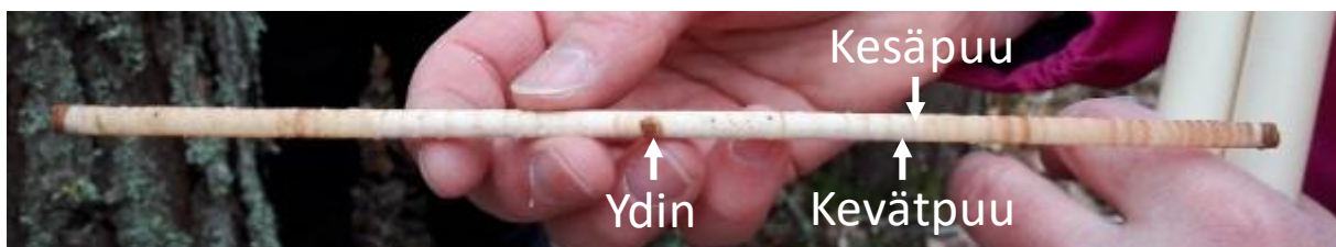
Kuva 1. Mäntyrunгон läpi ytimen kautta kairattu kasvukairanlastu. Rungon ydin näkyy keskellä tummana laikkuna. Vaaleat juovat ovat kevätpuuta ja tummat kesäpuuta. Sydänpuu erottuu vaaleana ja kuivana, pintapuuna tummana ja kosteana.
